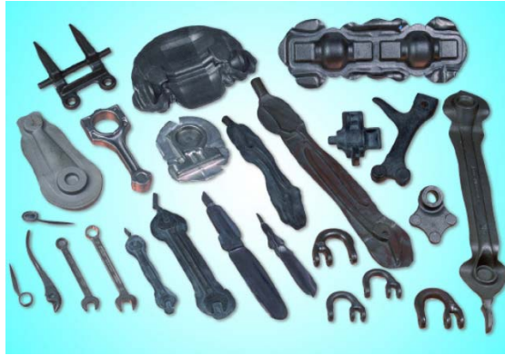
Slika 5.23 - Otkivci oblikovani na hidruličnim čekićima Lasco
