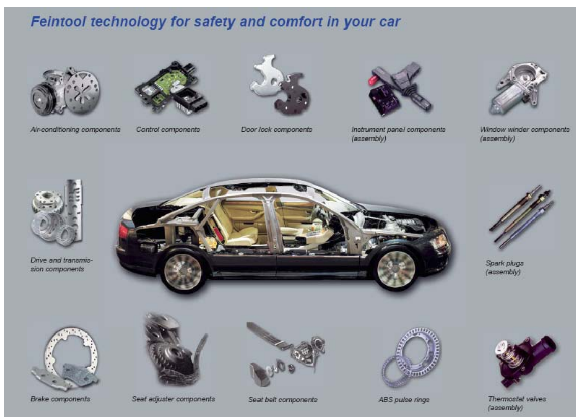
Slika 4.14- Delovi automobila proizvedeni finim razdvajanjem
