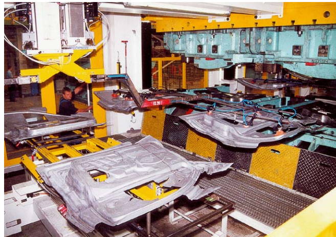
Slika 4.50- Transport obratka u automatskoj liniji sa međuskладиštem
