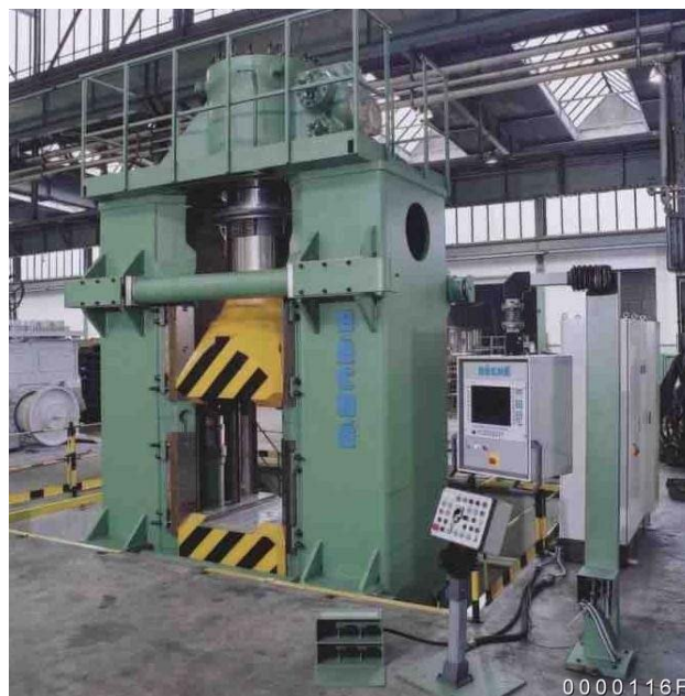
Slika 5.14 - Protivudarni vazdušni čekić Beche
