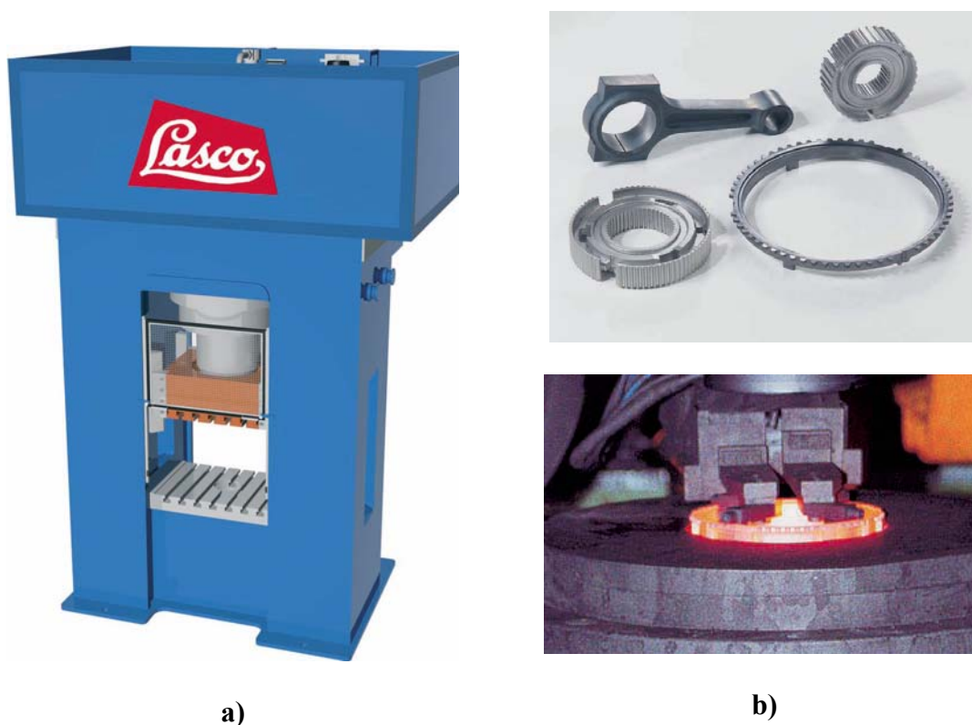
Slika 4.60- Hidraulična presa za kalibrisanje Lasco serije KP (a) i tipični delovi koji se kalibrišu nakon sinterovanja (b)
