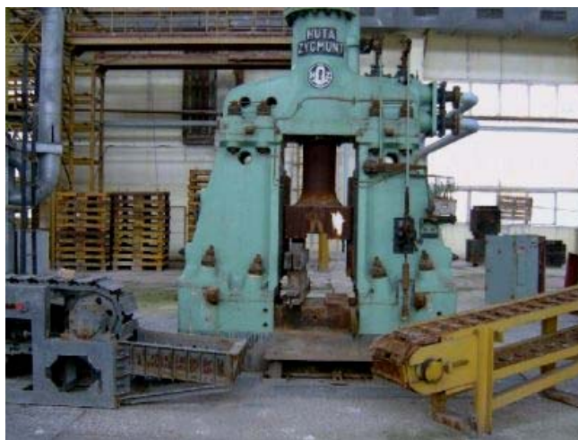
Slika 5.12 - Parovazdušni čekić Huta Zygmunt MPM 3150B, Poljska (1985) Nominalna energija 36 kJ, broj hodova 110/min., maksimalni hod 800 mm, masa nakovnja 24 t, ukupna masa 35 t, potrošnja vodene pare 650 kg/čas
