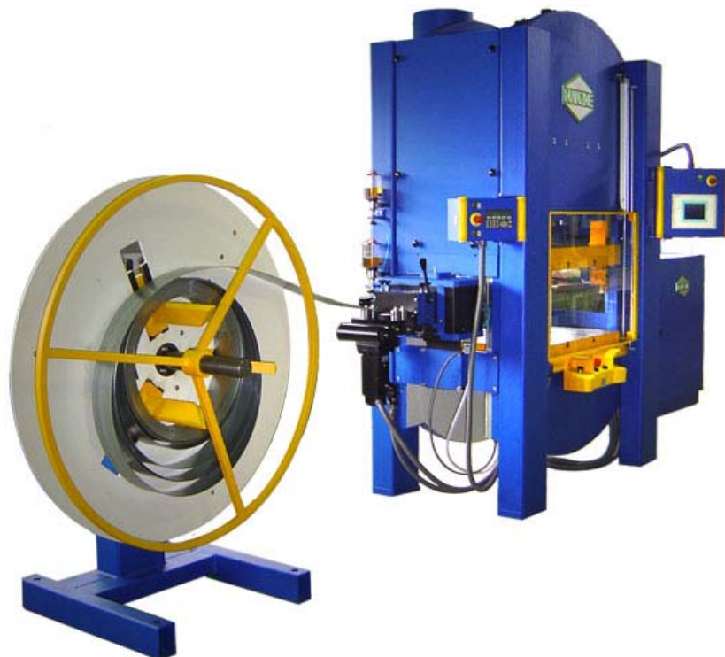
Slika 4.7. - Univerzalna presa primenjena za razdvajanje (Wanzke A-SPS 120)
