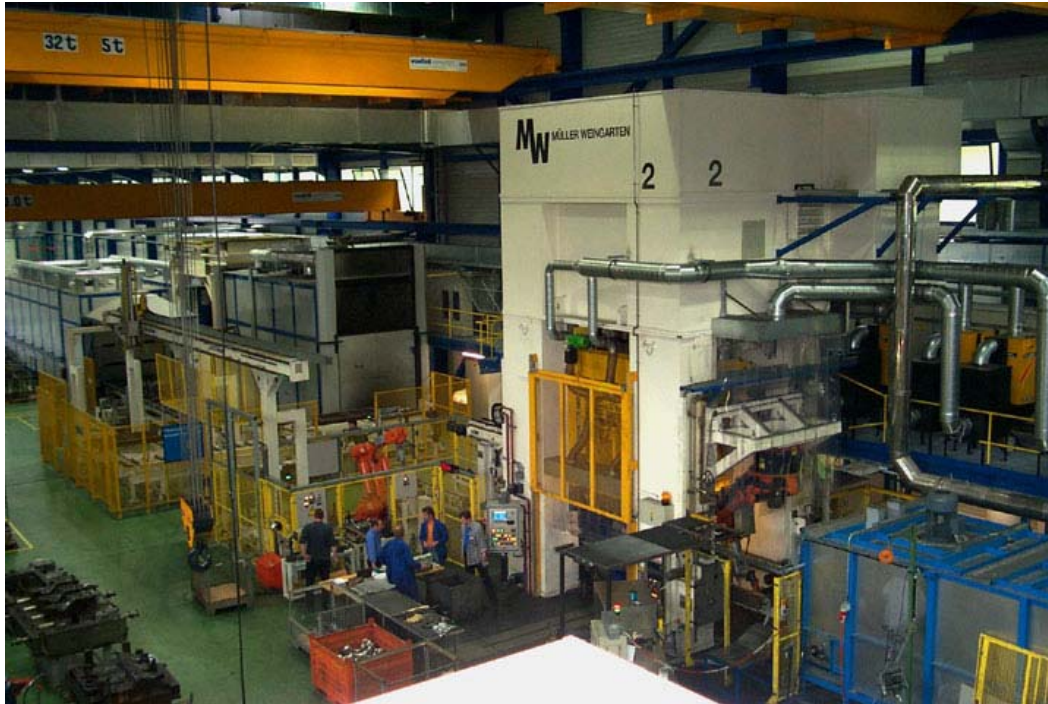
Slika 4.66 - Presa ZE u automatskoj liniji za kovanje (Müller Weingarten)
