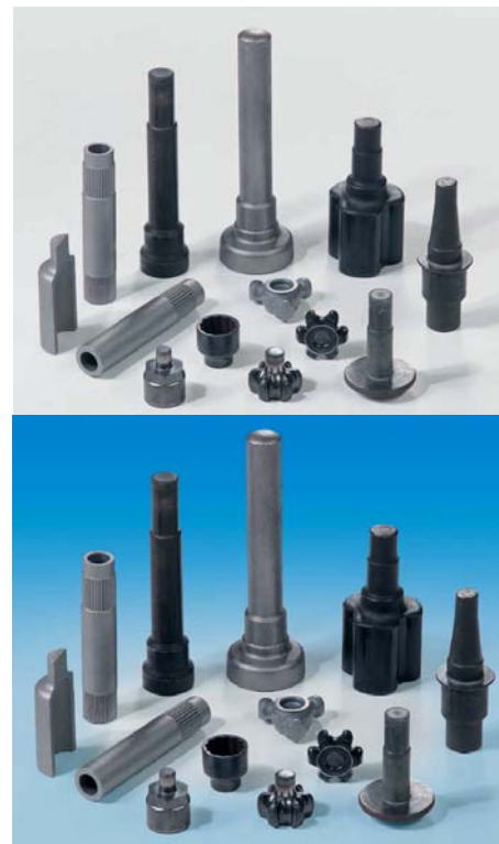
Slika 4.52- delovi izrađeni istiskivanjem na presi KFP
